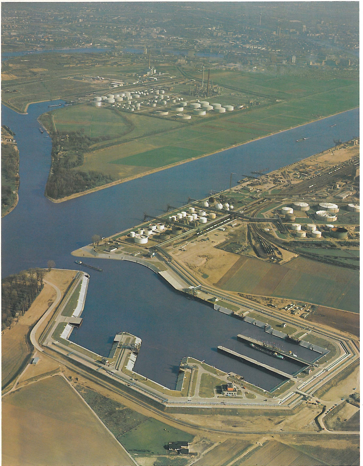
Der neue Landeshafen Ludwigshafen-Nord liegt unmittelbar an der nördlichen Grenze des Werkes Ludwigshafen. Im Interesse erhöhter Sicherheit für die Rheinschifffahrt wurde der Umschlag brennbarer Flüssigkeiten und brennbarer verflüssigter Gase in diesen Hafen verlegt. Luftbild Lossen, Freigabe-Nr. RPKA C 10/4161a.
