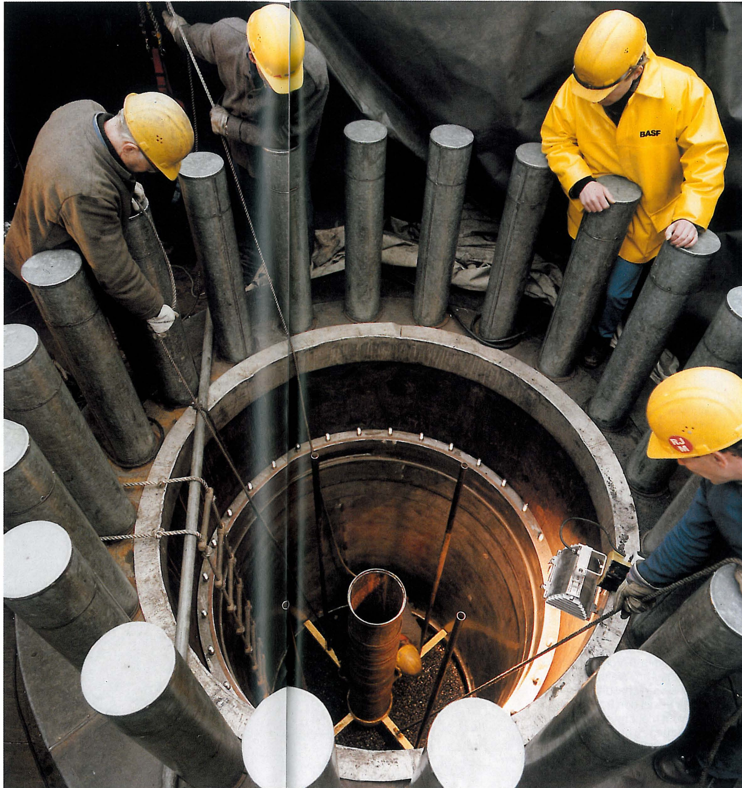
Befüllen eines Reaktors zur Produktion von Grundchemikalien mit einem neuen Katalysator. Für grundlegende Verfahren setzen wir Katalysatoren ein, die aus eigener Entwicklung und Produktion stammen.
