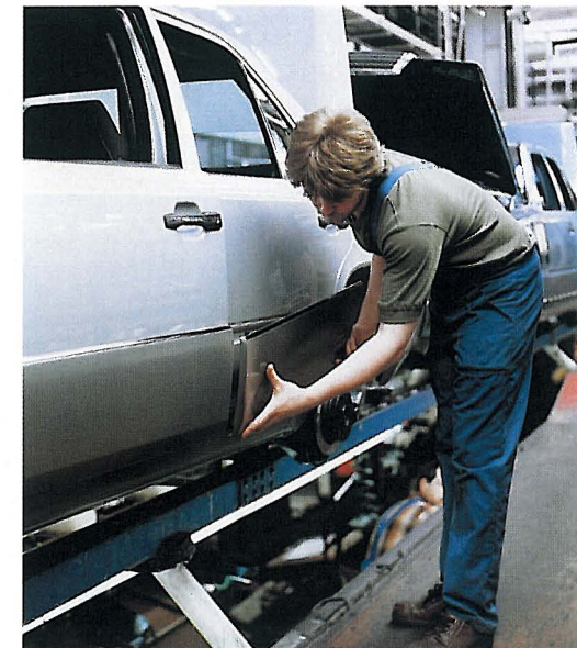
Markantes Merkmal der Baureihe W 124 von Mercedes sind die seitlichen Verkleidungen aus unserem thermoplastischen Polyurethan Elastollan®. Sie schützen an kritischen Stellen sicher vor Steinschlag und Korrosion.
