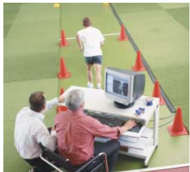
Intensive biomechanische Tests messen das Dämpfungssystem des Sportschuhs und die Auswirkung auf den Körper des Läufers.
