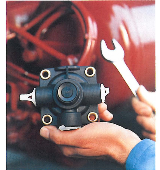
Im pneumatischen Bremssystem von Lastkraftwagen steuert ein Relaisventil den Betriebsdruck von Null bis 20 bar. Das Gehäuse dieses Sicherheitsteils wird aus einer Spezialmarke unserer Ultramid-Werkstoffe gefertigt.
