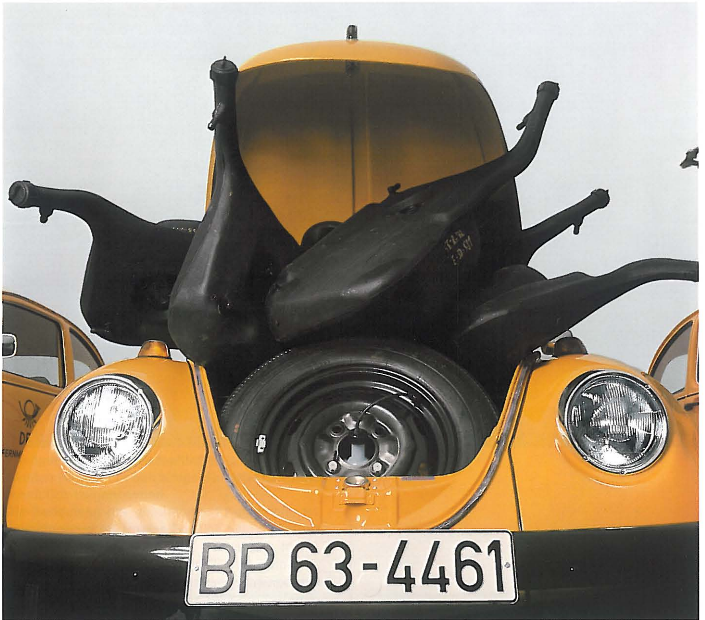
Großserienreifer Kraftstofftank aus Lupolen, eine Gemeinschaftsentwicklung der BASF und des Volkswagenwerks
