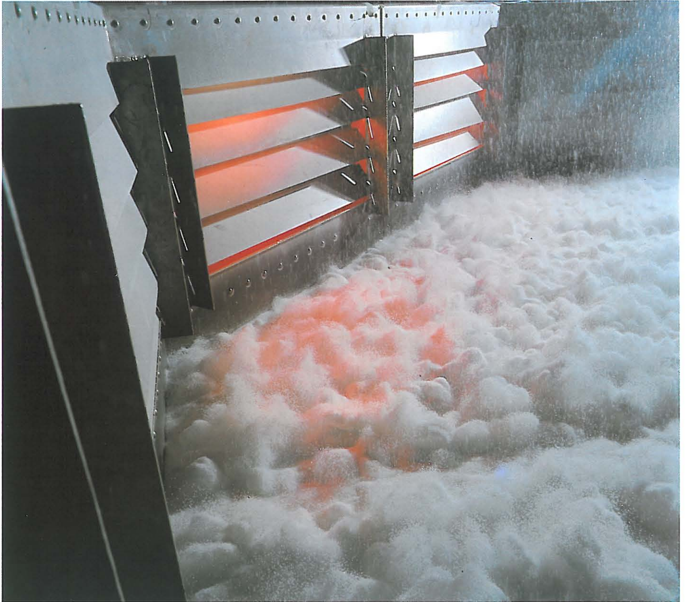
Kühlen von geprülltem Harnstoff in einer Wirbelschicht
