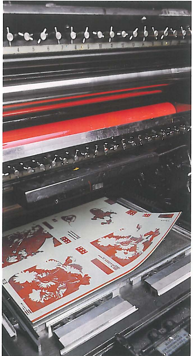
Nyloprint-Platten werden mit dem neuen „Nylospeed“-System schnell und rationell auf der Druckmaschine befestigt
