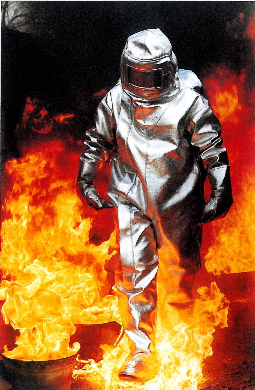
Dieser Brandschutzanzug ist aus Basofil® gefertigt – unserer neuen Synthefaser auf der Basis von Melaminharzen. Gewebe und Vliese aus Basofil halten Temperaturen bis +220° Celsius stand und sind zudem äußerst beständig gegen Chemikalien. Die Basofil-Faser ersetzt Asbest und ist eine kostengünstige Alternative zu Aramidfasern.
