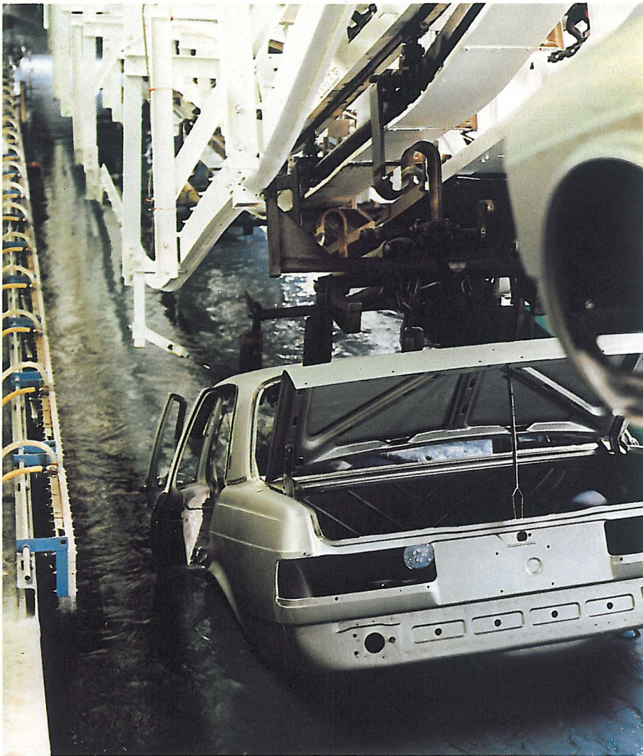
Das neue Verfahren der kathodischen Elektrotauchlackierung mit Cathodip führt zu einem wesentlich verbesserten Korrosionsschutz auch an den schwer zugänglichen Stellen einer Autokarosserie.
