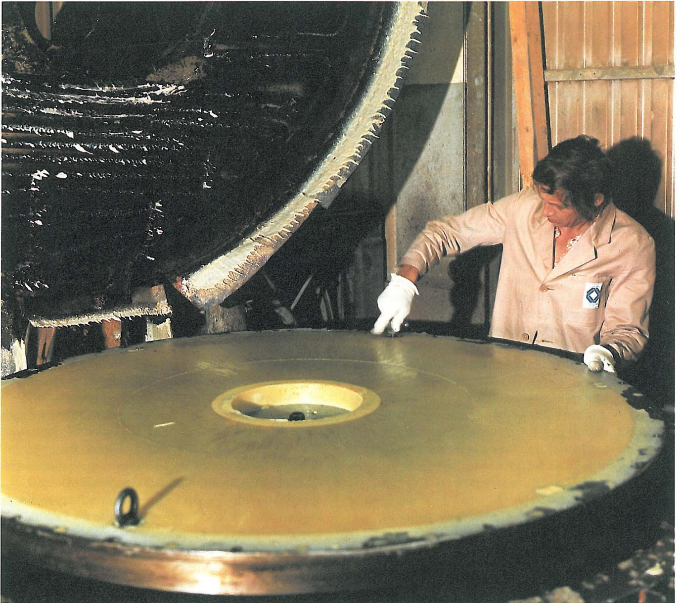
Herstellung von Großformteilen aus Polyurethan bei der Elastogran GmbH in Lemförde
