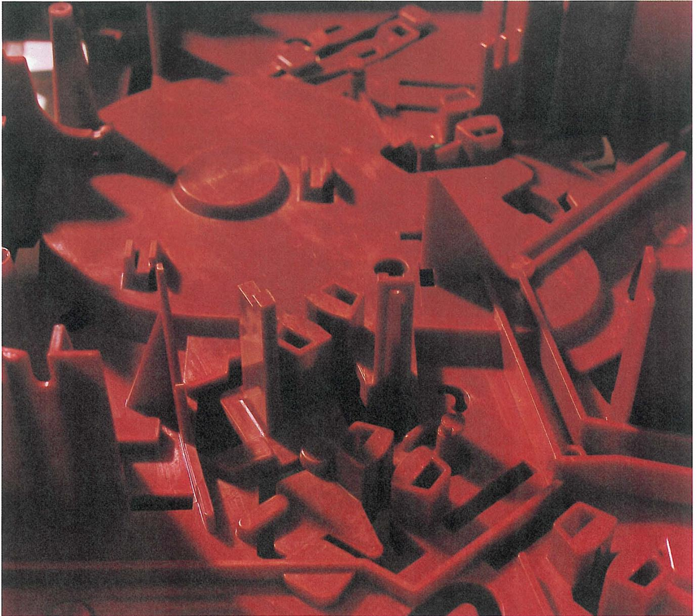
Chassis eines Tonbandgerätes. Das Formstück wird samt allen angeformten Funktionsteilen wie Halterungen, Durchbrüchen und Lagerstellen in einem Arbeitsgang aus dem Werkstoff Polystyrol im Spritzgußverfahren hergestellt
