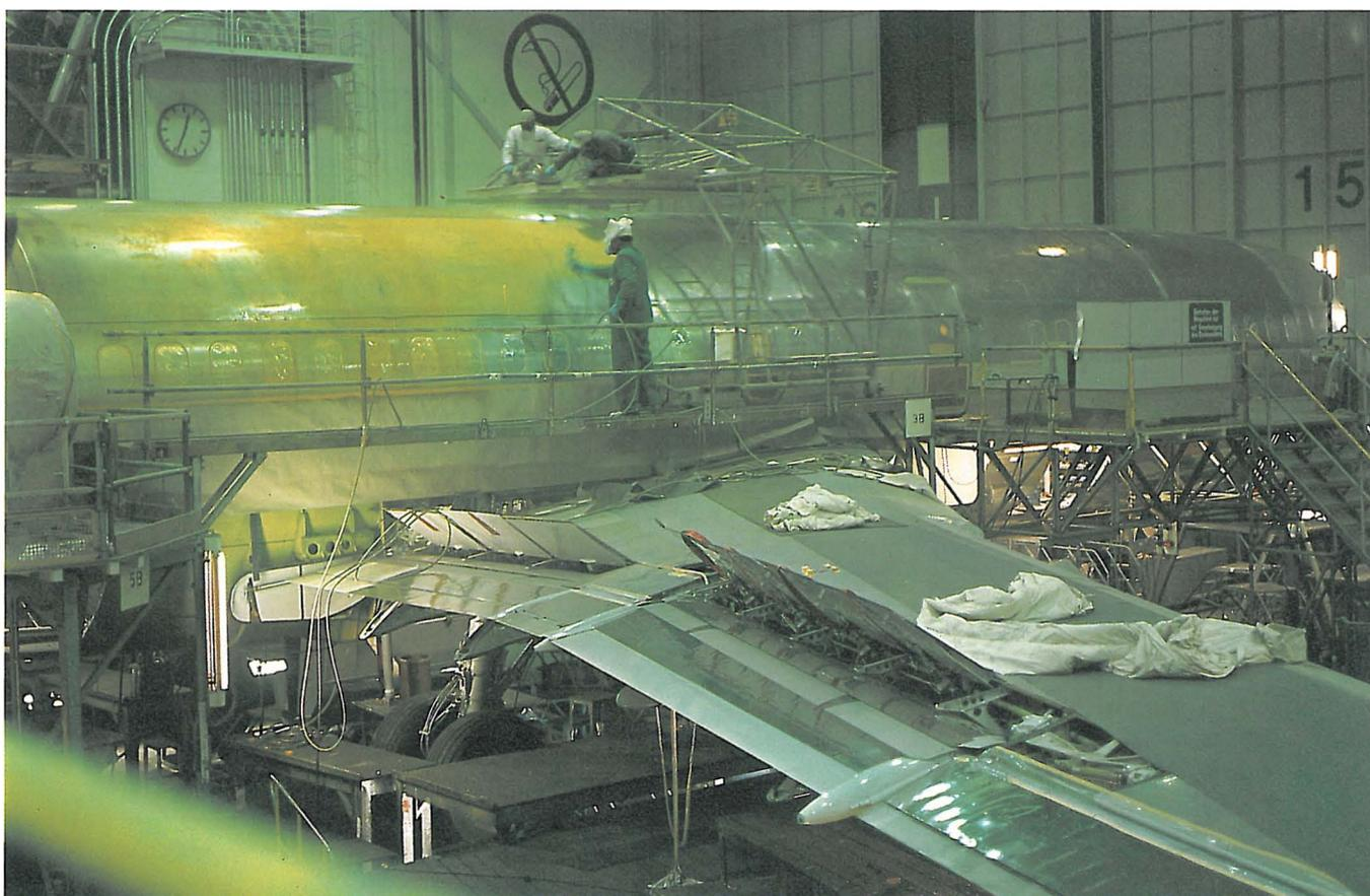
Lackierung von Flugzeugen mit Lacksystemen aus Polyurethan.
