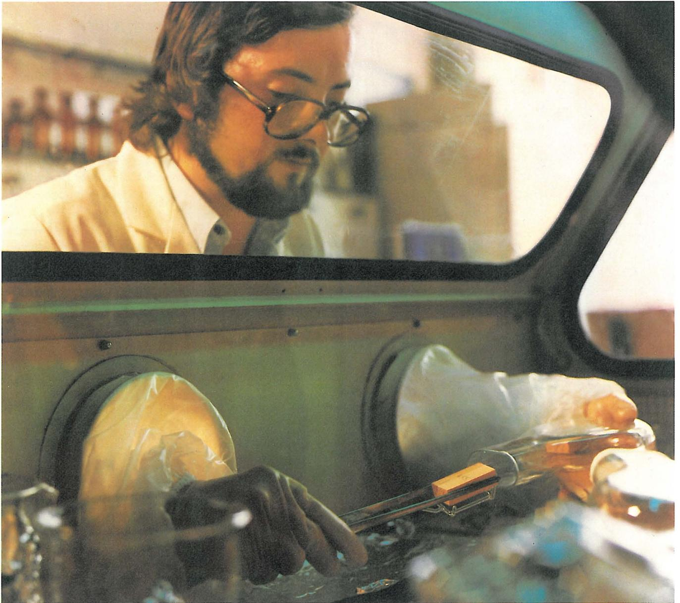
Zur Erprobung pilzhemmender Wirkstoffe wird ein Werkstoff mit Schadpilzen geimpft
