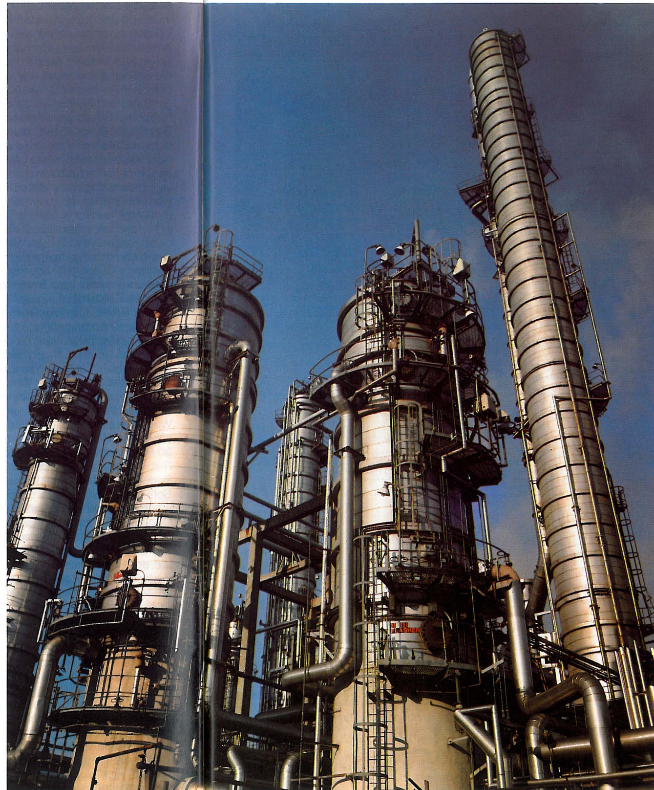
Das von uns erworbene Werk Seal Sands, Teesside/ Großbritannien, stärkt mit seinen hochmodernen Herstellungsverfahren unsere Wettbewerbsfähigkeit bei Vorprodukten für Fasern und Spezialkunststoffe. In der hier gezeigten Anlage wird Hexamethyldiamin, ein Vorprodukt für Polyamide und Polyurethane, hergestellt.
