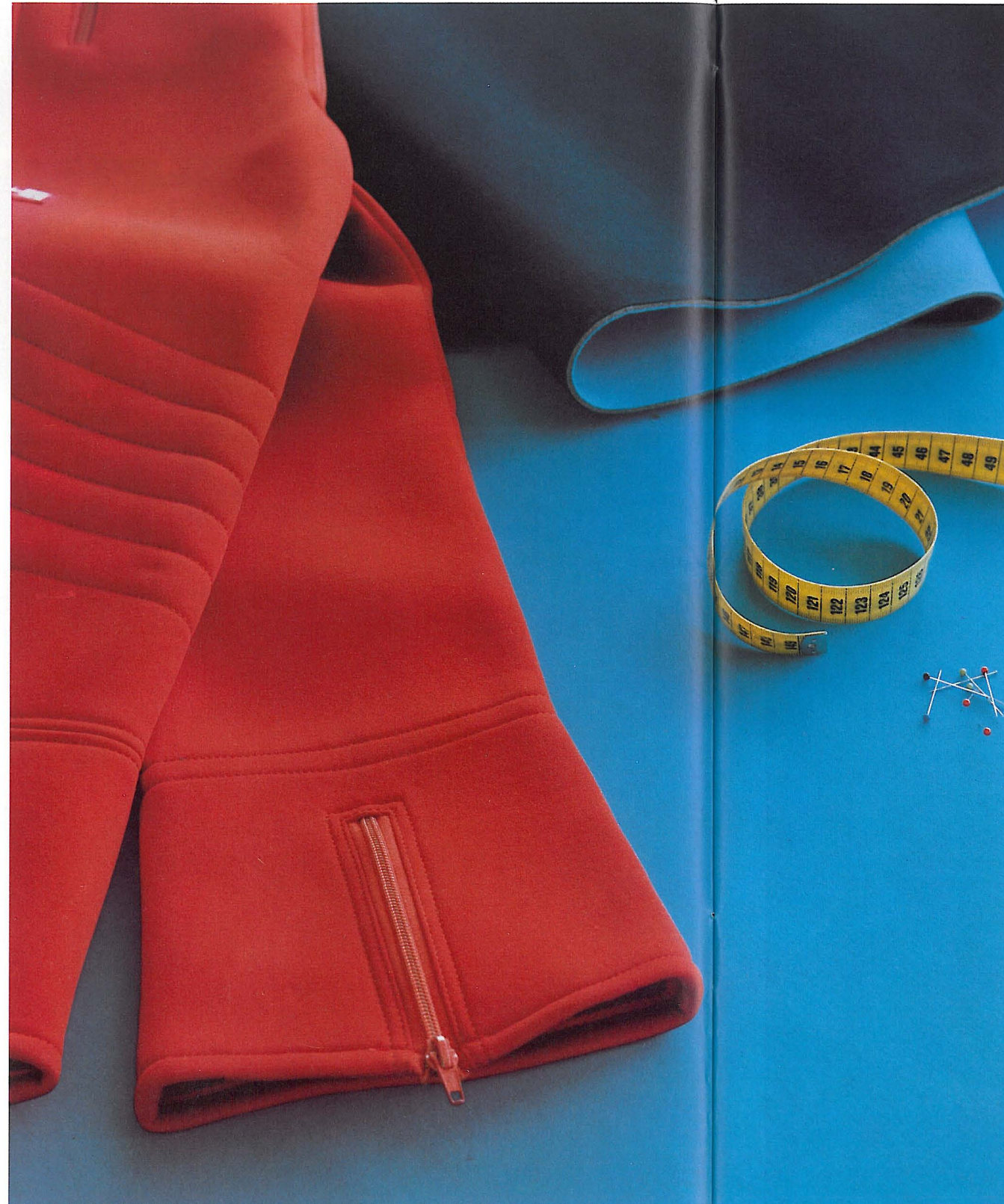
Skihosen müssen warm, elastisch und farbecht sein. Das Obermaterial dieser Jet-Hose besteht aus einem Gemisch von Wolle, texturierten Polyamidfasern und Elastomerfasern. Es wird mit unseren Acidol®-Farbstoffen in einem Arbeitsgang gefärbt. Außerdem ist die Wolle mit unserem Basolan® filzfrei ausgerüstet, der Griff des Gewebes durch Basosoft® verbessert, und als Nähgarn wurde mit Palanil®-Farbstoffen gefärbter Polyesterfaden verwendet.
