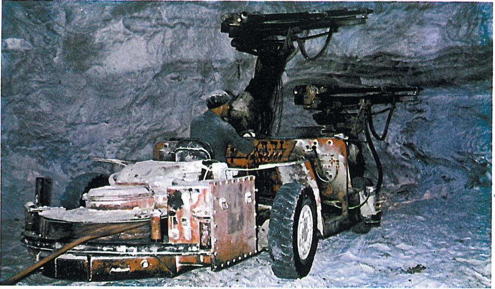
Bohrwagen im Kalibergbau der Wintershall AG
