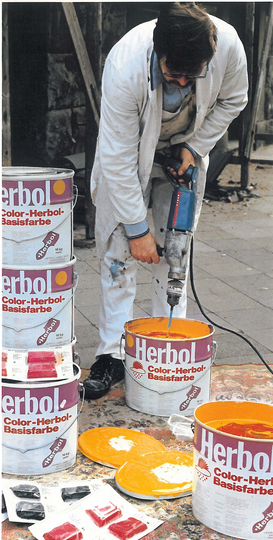
Für den Bautenanstrich erleichtert das ®Color-Herbol-System das Abtönen von Dispersionsfarben. Die 720 Farbtöne der Farbtonkarte werden durch Kombination von nur vier Farben erzielt.
