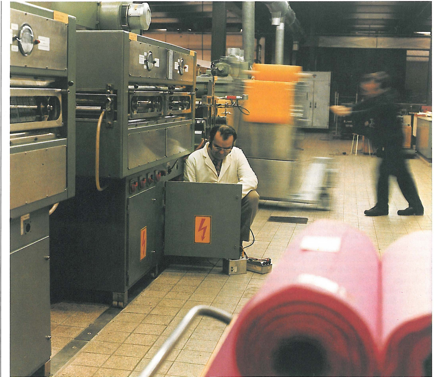
Teststraße für Textilveredlungsmittel im Anwendungstechnischen Laboratorium des Werkes Ludwigshafen. Die Straße wird mittels mobiler Aggregate an die jeweiligen Produktionsverfahren unserer Kunden angepaßt
