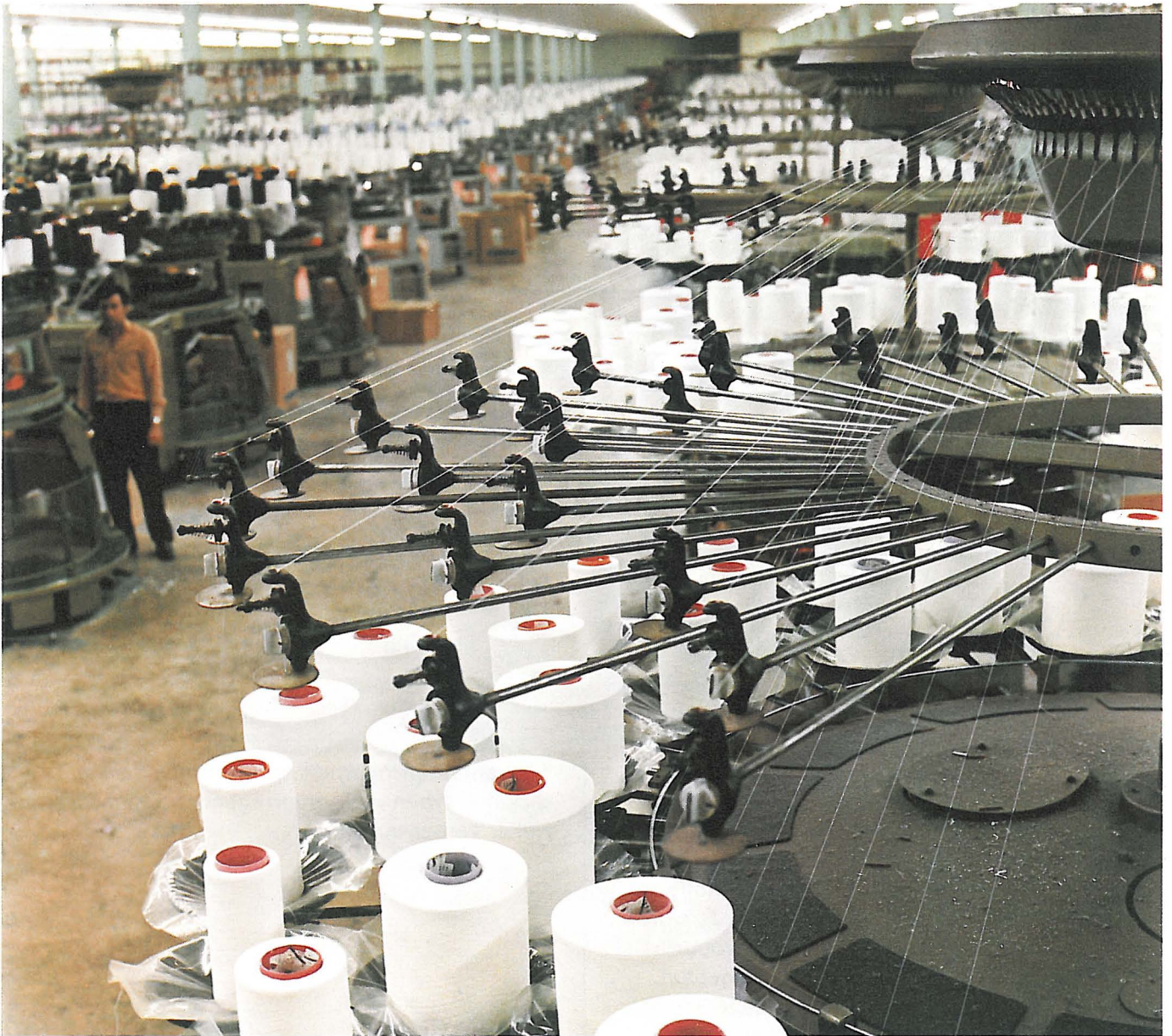
Rundstrickmaschinen zur Verarbeitung von Polyestergarnen in der Wirkerei bei Bentex Mills Inc., einer Beteiligungs- gesellschaft der Dow Badische Company
