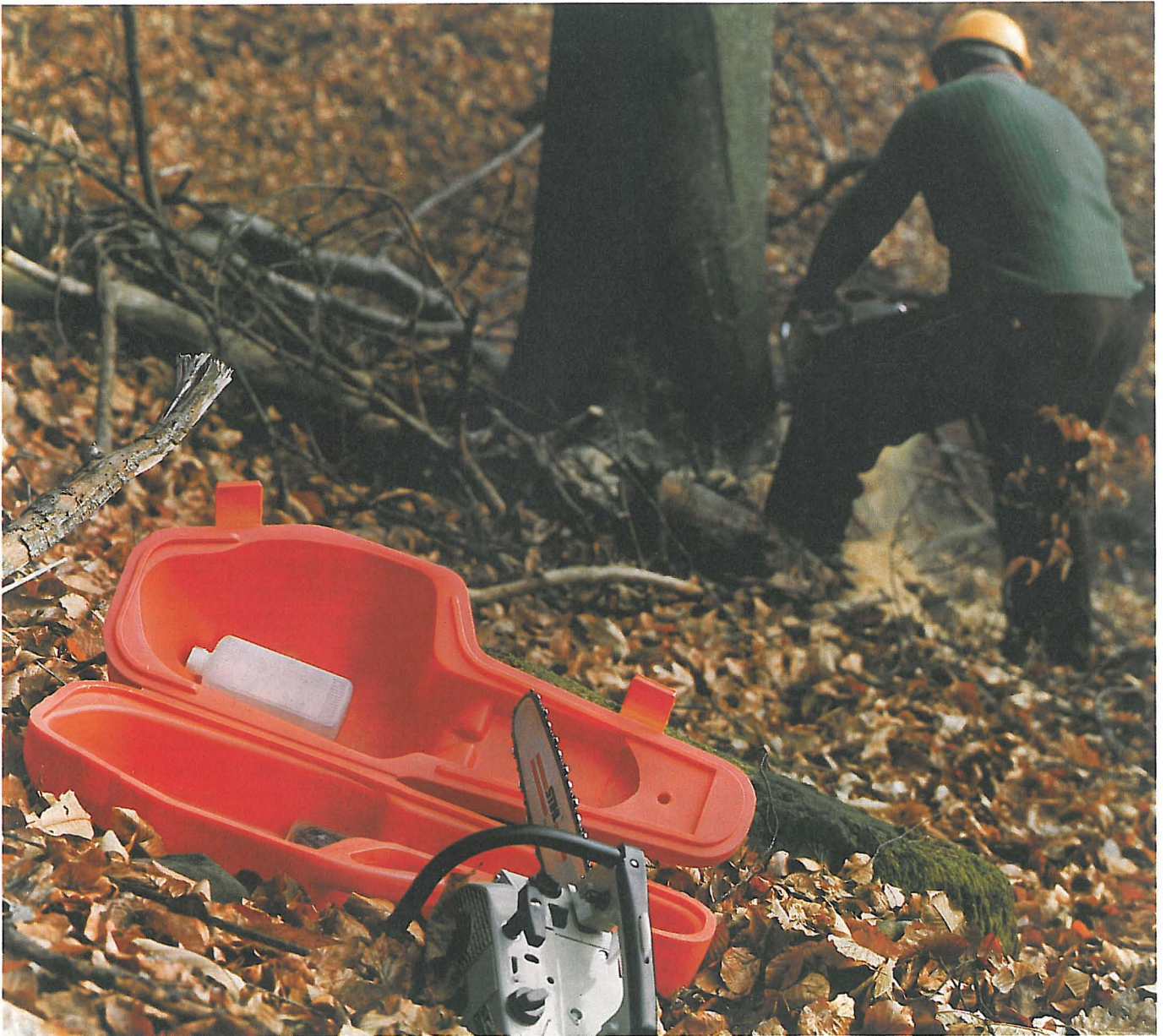
Boxet-Baumsägenverpackung; Koffer, Deckel und Scharnier werden in einem Arbeitsgang aus dem Werkstoff Lupolen geblasen (hergestellt von der Fa. Elbatainer; geschütztes Verfahren)
