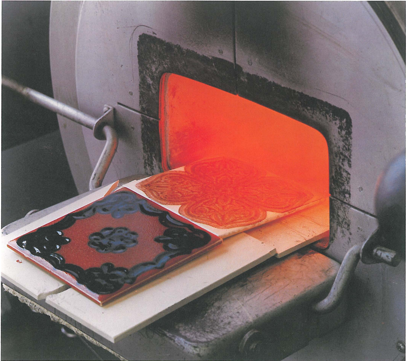
Testplatte im Werk Besigheim. Keramik-Reaktivfarben werden auf die gewünschte Einbrennwirkung geprüft
