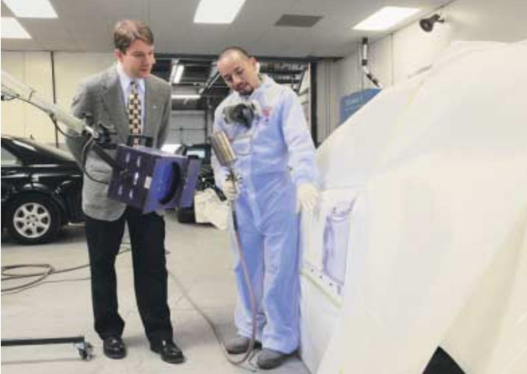
Mit Hilfe von UV-Lampen kann Mitchell Martinez, Mitarbeiter unseres Kunden American Service Center in Washington/USA, beschädigte Kraftfahrzeuge schneller reparieren. Der eingesetzte BASF-Lack trocknet minutenschnell, eine aufwendige Erhitzung im Heizofen entfällt.
