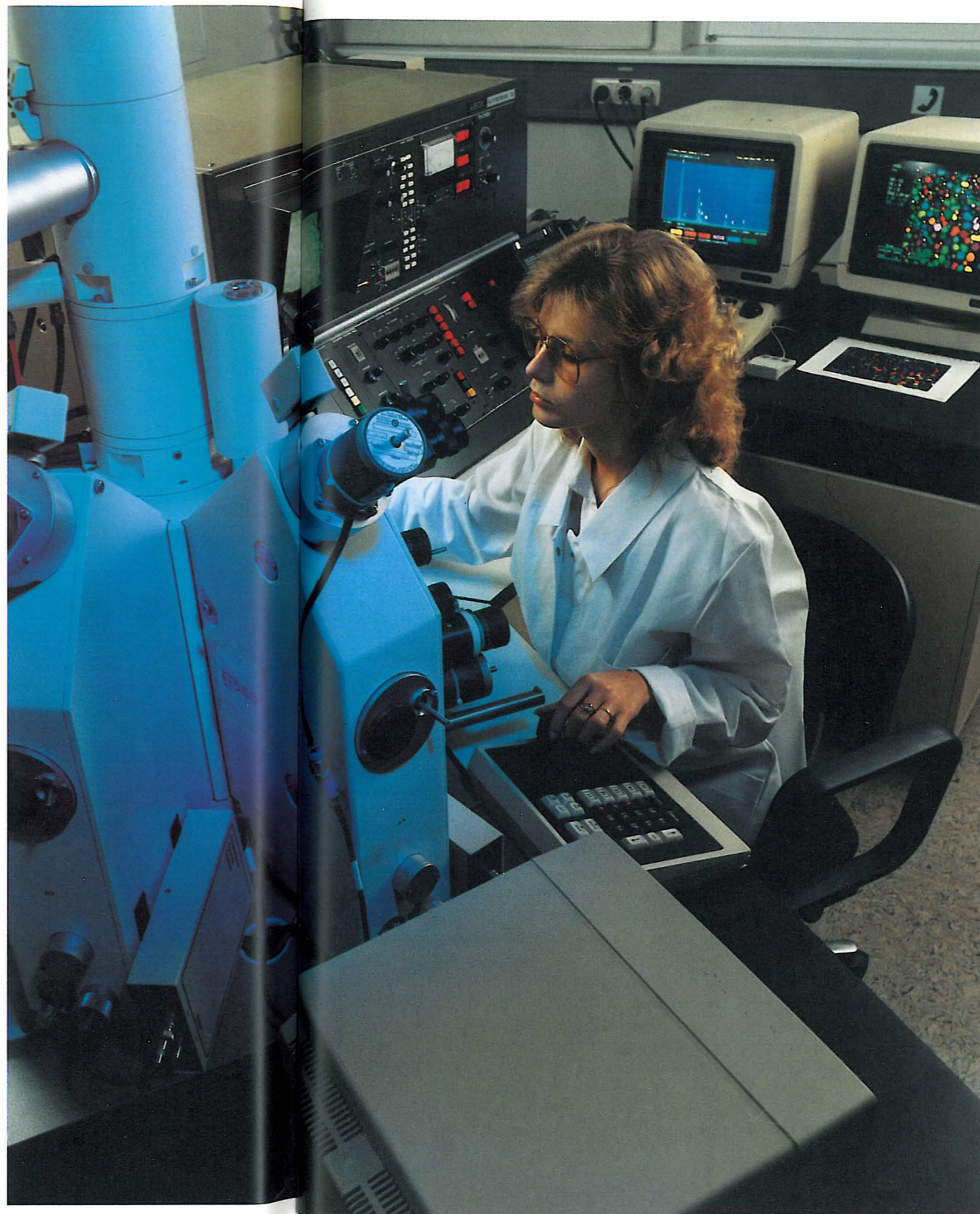
Dieses Hochleistungs-Transmissions-Elektronenmikroskop, das erste Gerät dieser Leistungsklasse in Deutschland, erlaubt Vergrößerungen bis zum 800 000fachen und damit den Einblick in atomare Strukturen. Wir nutzen dieses Gerät für unsere Katalysator- und Materialforschung.
