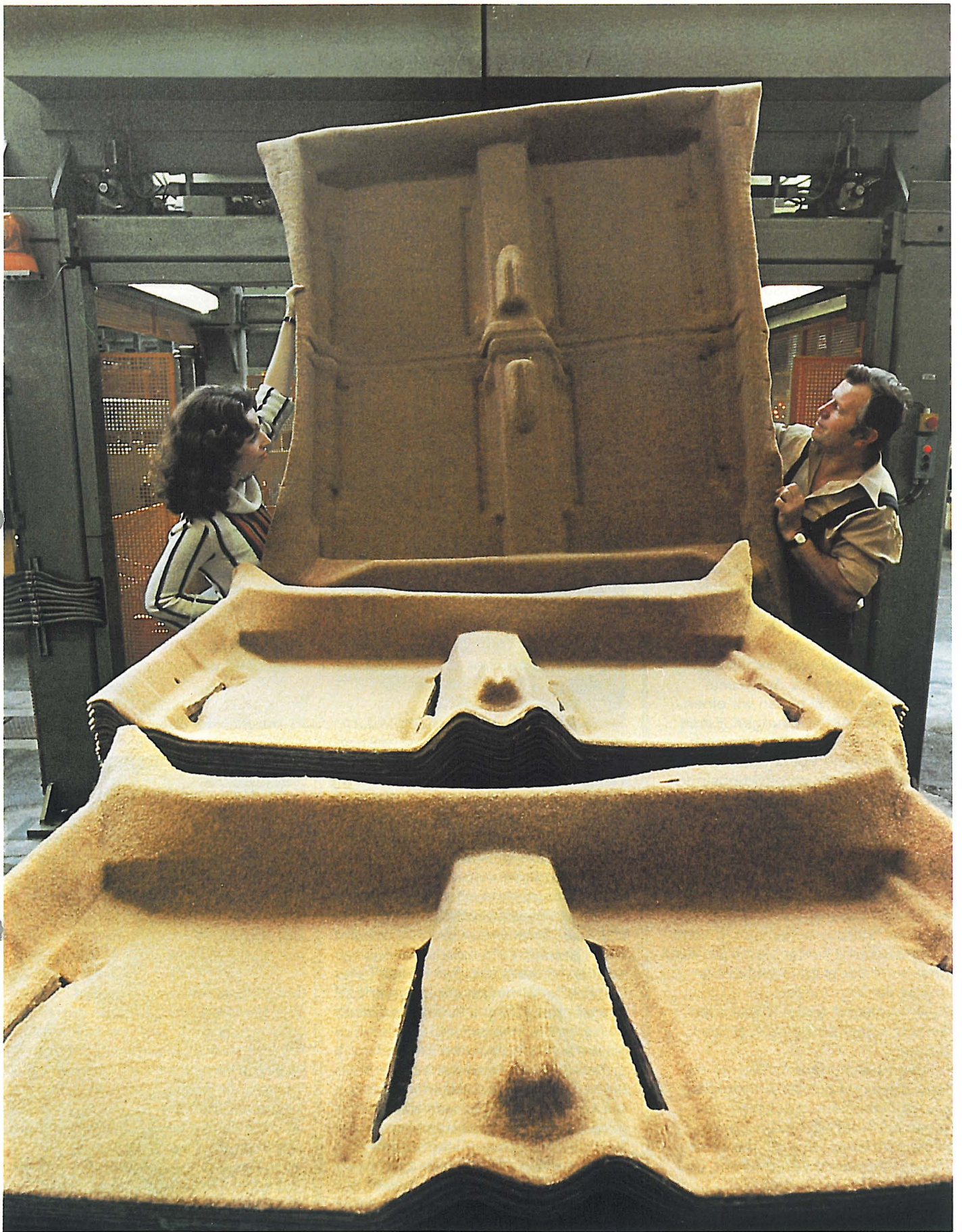
Im Tiefziehverfahren gefertigter, mit speziellen ®Butofan-Dispersionen verfestigter Nadelfilz- bodenbelag für die Innenausstattung von Perso- nenkraftwagen.
