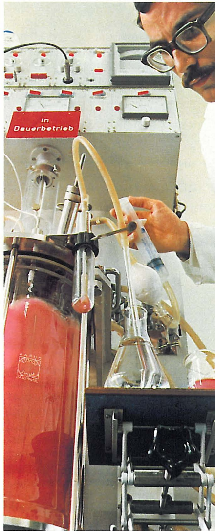
In biotechnischen Reaktionen nutzen wir die Synthesemöglichkeiten der lebenden Zelle und gelangen so zu spezifischen Wirkstoffen. Das Bild zeigt einen Laborfermenter für präparative Arbeiten im Hauptlaboratorium des Werkes Ludwigshafen.
