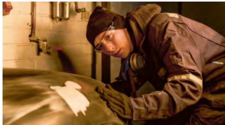
Karosserieteile werden mit Kitt gefüllt und abschließend mit Spachtelmasse und Grundierung lackierfertig geschliffen.
