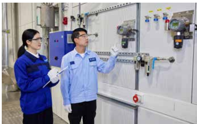
选择催化还原(SCR)催化剂性能测试前, 机动车排放催化剂上海发动机试验室内的研发人员正在检查和确认各传感器和分析仪测量通道。
