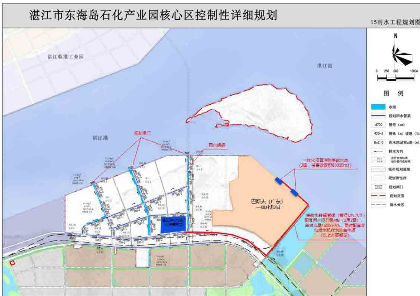
图 6.9-5 一体化项目消防事故水池至园区公共事故池转输管线路由方案示意图
