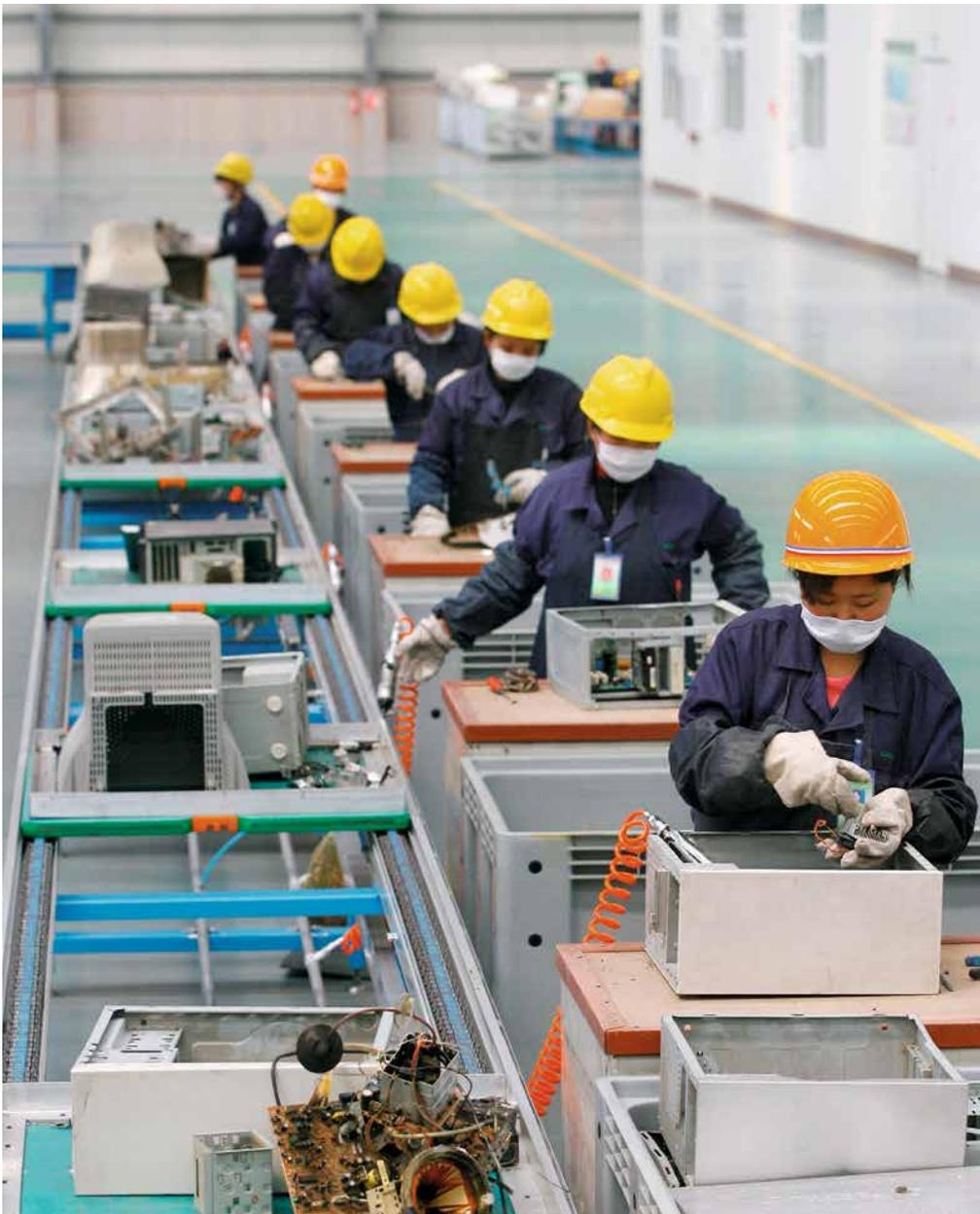
Mitarbeiter zerlegen Elektroschrott in einer Abfallwiederverwertungsanlage in Wuhan in der Provinz Hubei. Die Kunststoffteile werden für die Produktion von Holz-Faser-Verbundwerkstoffen wiederverwertet.
