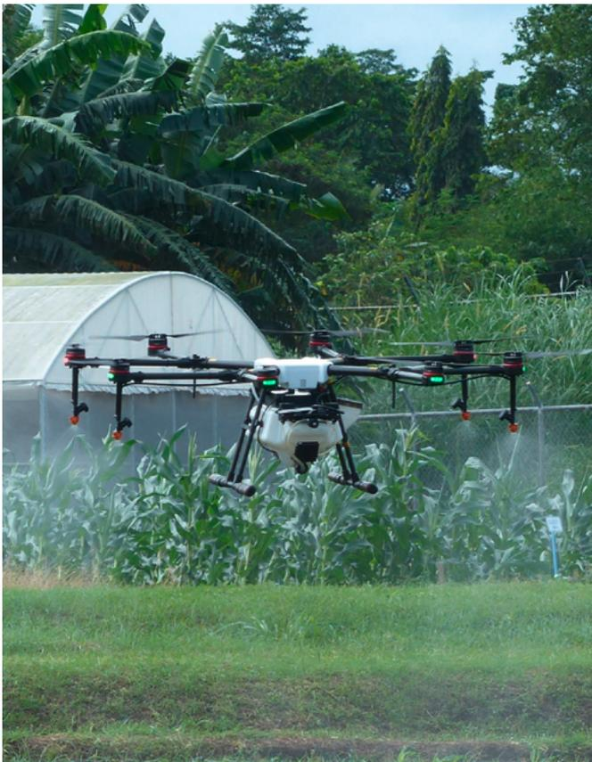
*Los drones se pueden utilizar para aumentar la seguridad y la productividad en agricultura. Las principales ventajas en comparación con la fumigación convencional con mochila optimiza el uso de productos fitosanitarios, riesgo reducido de contacto con el producto y alta eficiencia en la aplicación y recolección de información.*
