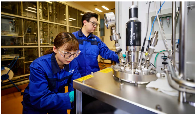
兩名研究員在上海創新園的安全技術實驗室進行反應量熱實驗。
