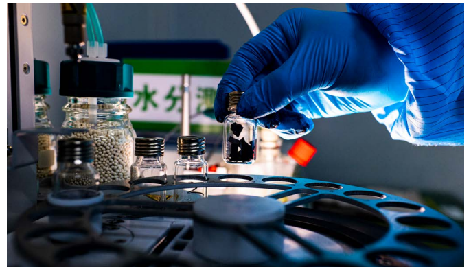
在巴斯夫杉杉分析與電池技術中心，測試員正在進行正極片水分測試。
