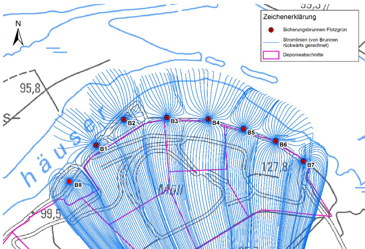
Abbildung 4: Zuströmung zu den Abschirmbrunnen gemäß Grundwassermodell
