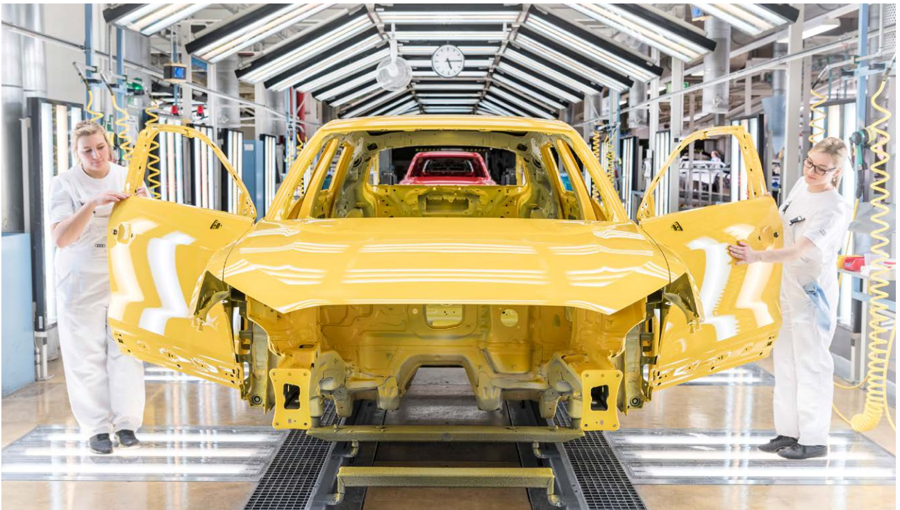
巴斯夫水性底漆系統幫助減少汽車製造商塗裝廠的VOC排放。
