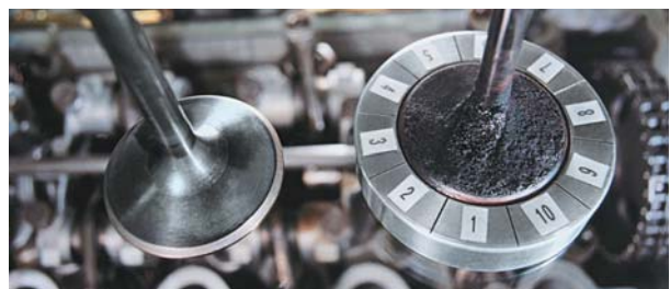
对比显示：快乐跑®燃油添加剂（Keropur®）如何防止进气阀形成积碳。
