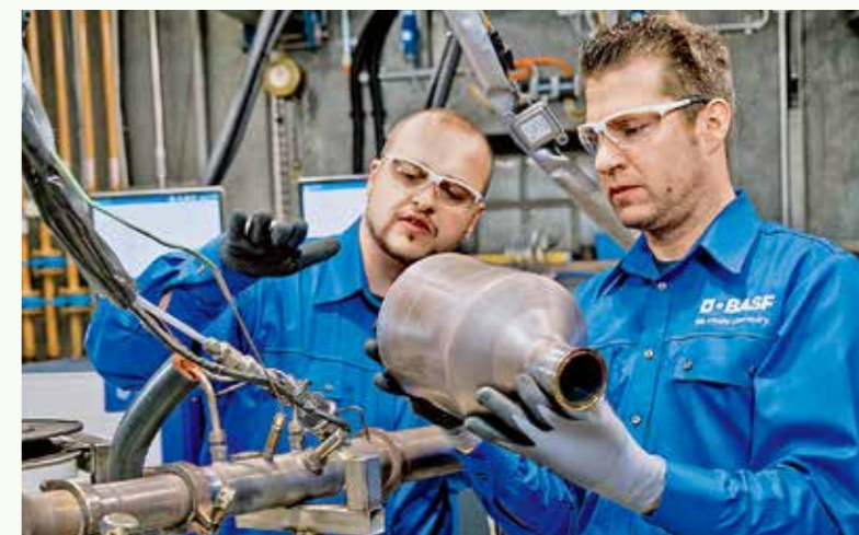
在巴斯夫位于汉诺威的发动机实验室中，研究人员正在测试未来催化剂技术的功能与耐用性。
