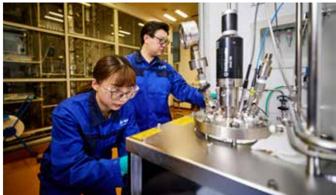
两名研究员在位于上海创新园的安全技术实验室进行反应量热实验。
