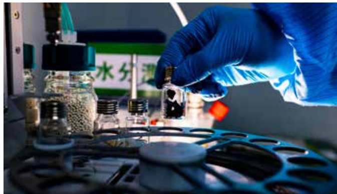
在巴斯夫杉杉分析与电池技术中心，测试员正在对正极片进行水分测试。
