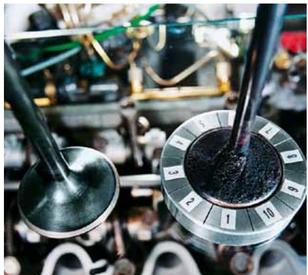
La comparación muestra como Keropur® protege a las válvulas de los depósitos.
