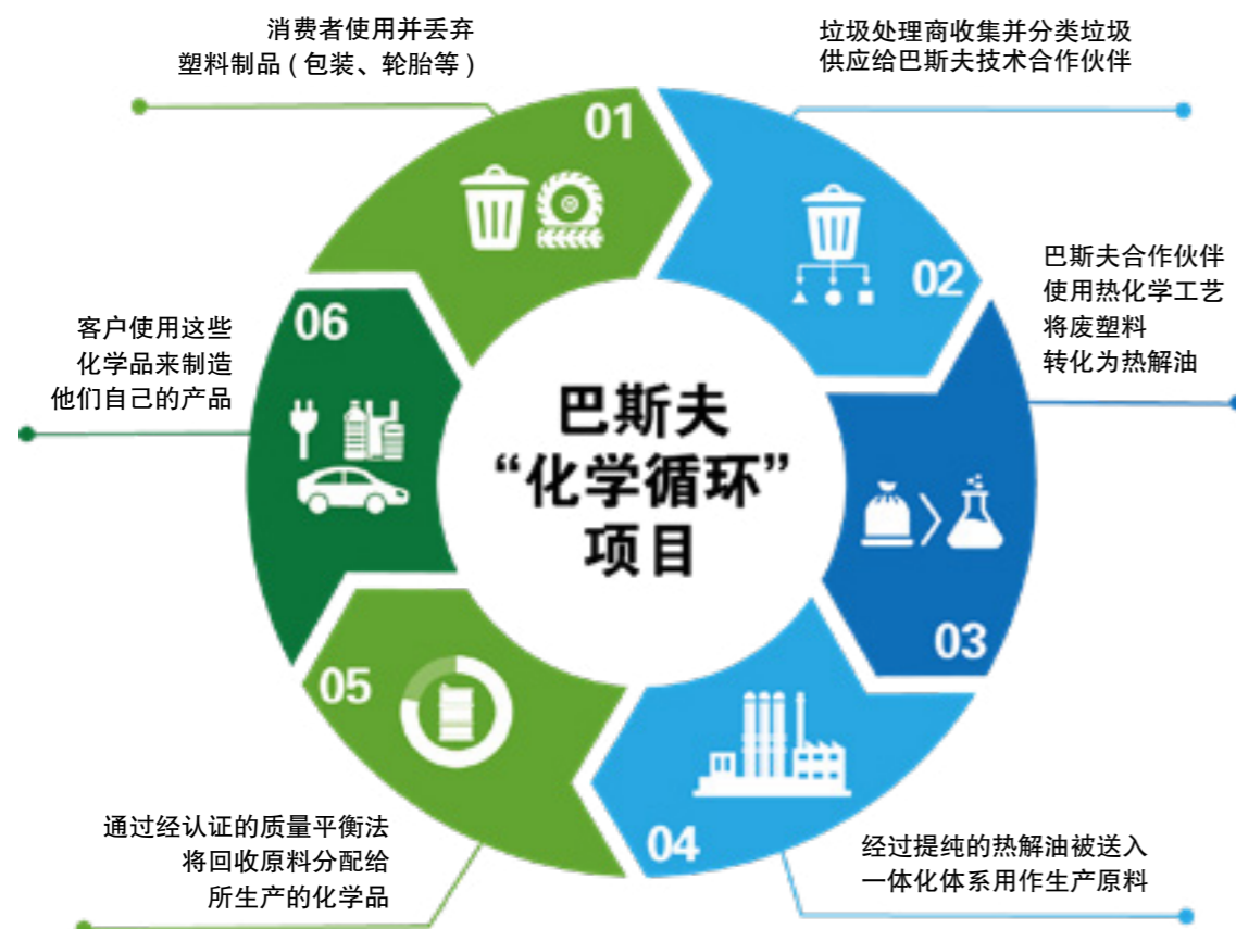
在“化学循环”项目中，我们的技术合作伙伴利用热化学工艺将塑料废弃物转化为原材料（热解油）。
