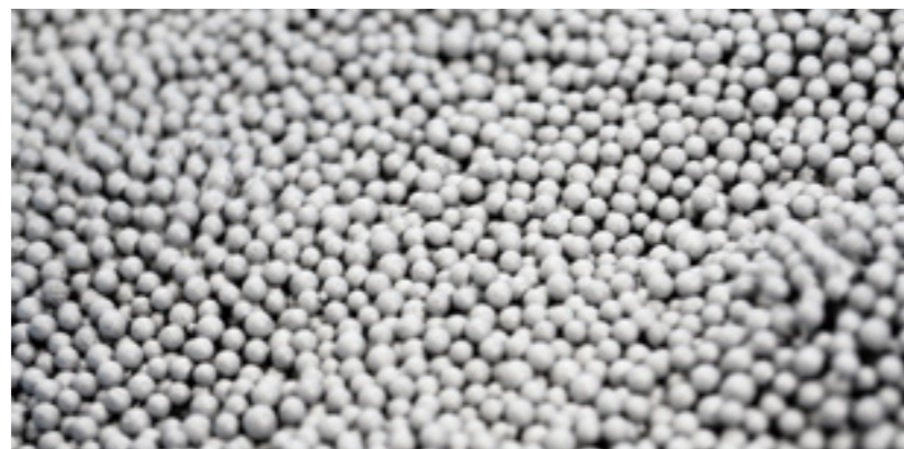
巴斯夫生产的是 Neopor® 灰色粒子，保温材料生产商可以将其加工成板材和特殊的形状。首先利用蒸汽发泡原材料，使其体积膨胀达原来的 50 倍。Neopor® 粒子遇热融化，在专用模具中制作成块、板或其他形状。
