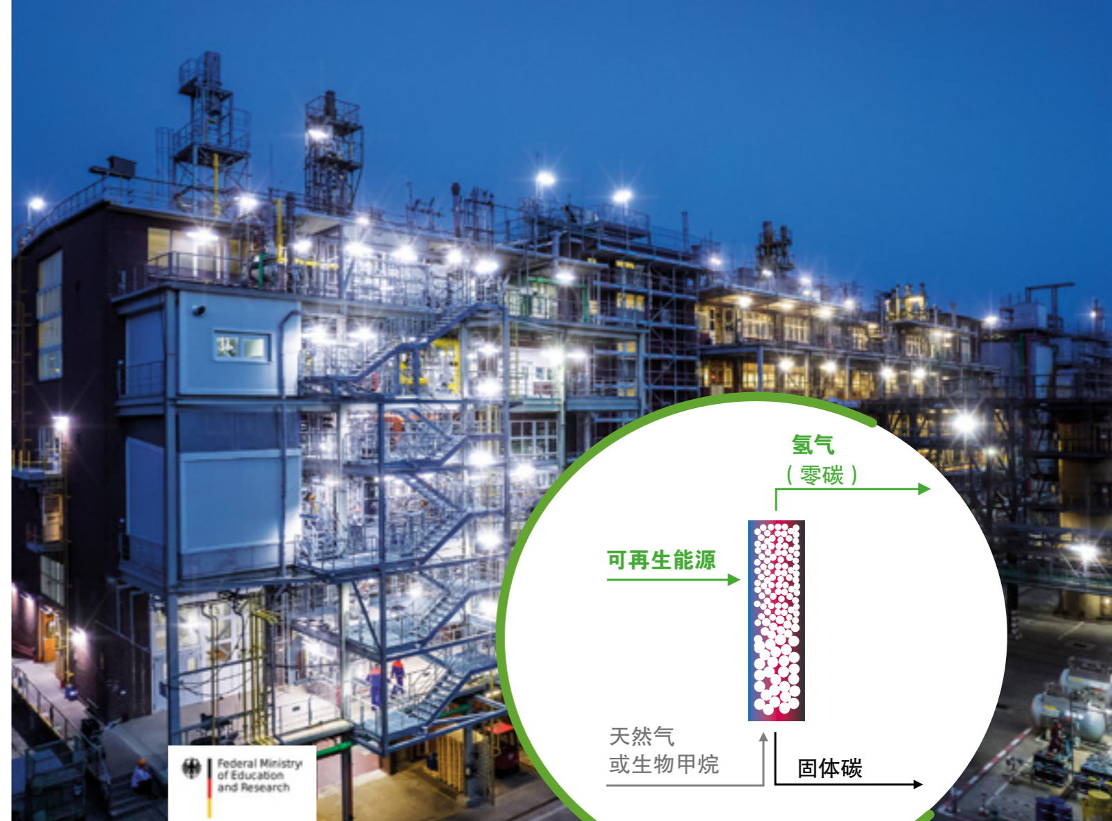
二氧化碳减排新工艺—甲烷裂解制氢示意图。 该创新工艺直接将(生物)甲烷分解成氢气和固体碳。
