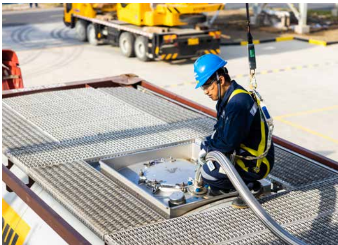
高空作業時，作業人員必須穿戴包括防墜落保護設施在內的個人防護用具。
