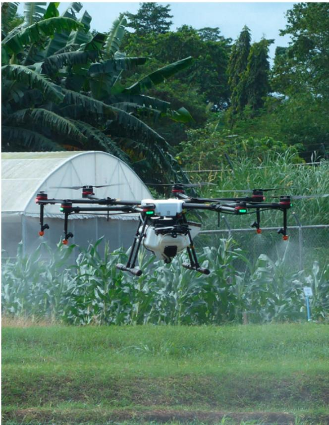
*Drones podem ser usados para aumentar a segurança e a produtividade na agricultura. As principais vantagens em comparação com a pulverização costal convencional é o uso otimizado de produtos fitofarmacêuticos, risco reduzido de contato com o produto e alta eficiência na aplicação e coleta de Informação.*
