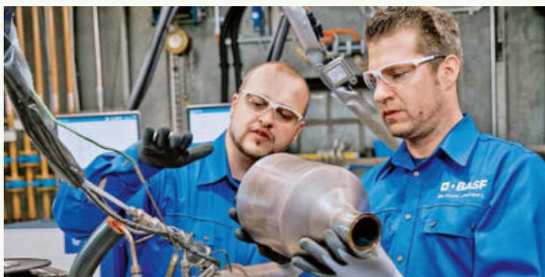
Im Motorenlabor von BASF in Hannover werden Funktionalität und Dauerhaltbarkeit künftiger Katalysatoren-Technologien getestet.
